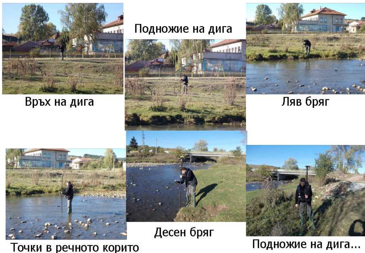
Фиг. 37: Пример за местоположение на точките за измерване в речен профил.
