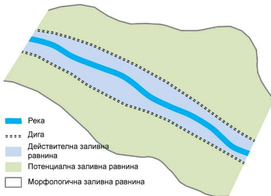
Фигура 3: Схематично представяне на действителната (активна) заливна равнина, морфологичната заливна равнина и потенциалната заливна равнина
